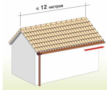
Если конфигурация крыши соответствует рисунку (ничего не препятствует линейному расширению желоба) и ее длина не превышает 12 м, то достаточно установить одну воронку желоба (без резиновых уплотнителей) в конце уклона желоба, если площадь кровли соответствует гидравлическим характеристикам выбранной системы.
